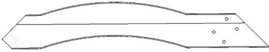
C02 | CORBEAU AVEC ÉTIQUETTE - W2A03371 (1) 1 3/8 po x 6 7/16 po x 36 1/4 po (36 x 163 x 921)
